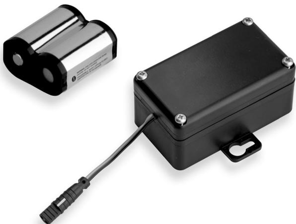
IT Il rubinetto elettronico è alimentato con batteria CC 6V CR-P2 lithium, grado di protezione della scatola (IP53), la cui durata è mediamente di due anni circa. Quando la batteria comincia a scaricarsi, il led emette brevi impulsi per un tempo massimo di 30 sec. A scaricamento completo, la valvola si chiude, non permettendo l'utilizzo del rubinetto.
